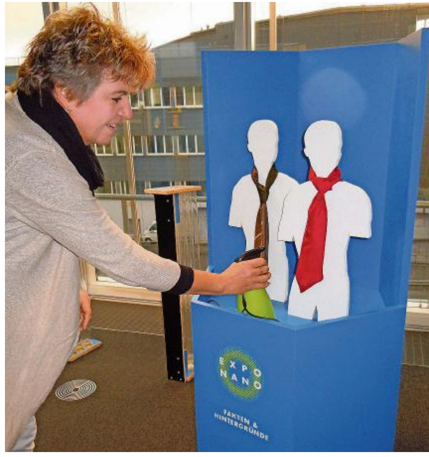
Der Lotus-Effekt: Helen Dietsche, Hightech Zentrum Aargau, besprüht eine beschichtete Krawatte – und schon perlt das Wasser ab. EF.
