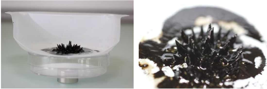
Abbildung 4: Igelstrukturen im Ferrofluid: Rosensweig- oder Stachel-Instabilität, 1966 entdeckt von dem Physiker Ronald E. Rosensweig. Das Ferrofluid befindet sich in einem Gleichgewicht zwischen Magnetischer Kraft, der Gravitation sowie der Oberflächenspannung der Flüssigkeit. (Bilder: Swiss Nano-Cube)
