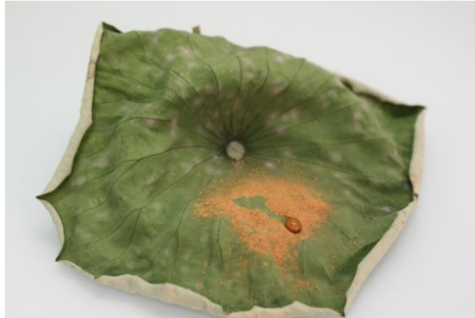
Abbildung 9: Getrocknetes Lotusblatt mit feinzermahlenem Ton und einem Wassertropfen. (Bild: Swiss Nano-Cube)
