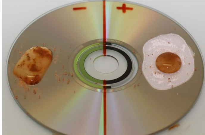
Abbildung 16: Lotus-Effekt auf einer CD. Links: Unbehandelt. Rechts: Mit Aceton behandelte raue Fläche (weisser Fleck). (Bild: Swiss Nano-Cube)
