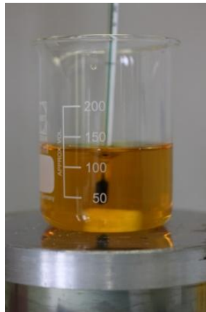
Abbildung 2: (a) 50 mM Ammoniumeisen(II)-Sulfat Lösung. (b) Ammoniumeisen(II)-Sulfat Lösung kurz nach der Zugabe der Di-Ammoniumoxalat Lösung. (c) Ausfällung des Di-Ammoniumeisen-Di-Oxalats. (Bilder: Swiss Nano-Cube)
