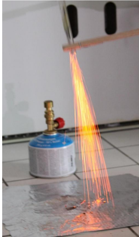
Abbildung 4: Spontane Verbrennung des pyrophoren Eisens. (Bild: Swiss Nano-Cube)
