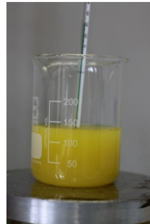
Abbildung 2: (a) 50 mM Ammoniumeisen(II)-Sulfat Lösung. (b) Ammoniumeisen(II)-Sulfat Lösung kurz nach der Zugabe der Di-Ammoniumoxalat Lösung. (c) Ausfällung des Di-Ammoniumeisen-Di-Oxalats. (Bilder: Swiss Nano-Cube)
