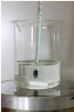
Abbildung 2: (a) 50 mM Ammoniumeisen(II)-Sulfat Lösung. (b) Ammoniumeisen(II)-Sulfat Lösung kurz nach der Zugabe der Di-Ammoniumoxalat Lösung. (c) Ausfällung des Di-Ammoniumeisen-Di-Oxalats. (Bilder: Swiss Nano-Cube)
